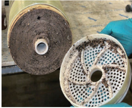
图 10.5.3 首支膜元件进水端板处污染物
